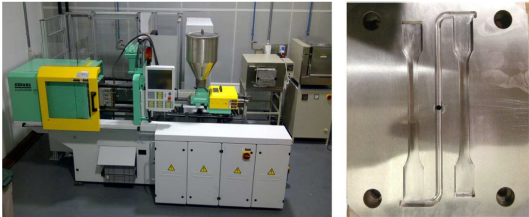
Obr. 3.1 Vstřikovací stroj Arburg 270 S 400-100 (vlevo), univerzální dvoudesková vstřikovací forma pro výrobu víceúčelových zkušebních těles (vpravo)
