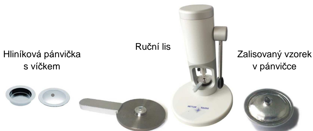
Obr. 3.6 Postup přípravy vzorků pro DSC analýzu
