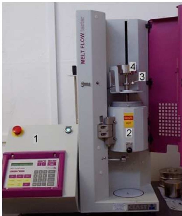
Obr. 3.14 Výtlačný plastometr MeltFlow Index Tester Model 6932 1) řídicí panel; 2) válec; 3) píst; 4) závaží [40]
