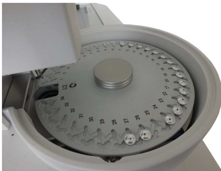
Obr. 3.8 Zásobník kalorimetru Mettler Toledo DSC 1/700 s automatickým podavačem vzorků
