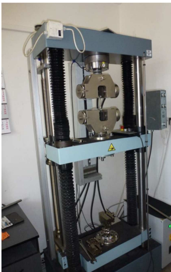
Obr. 3.17 Trhací zařízení TiraTest 2300, vpravo zařízení TiraTest 2300 s použitím průtahoměru Epsilon
