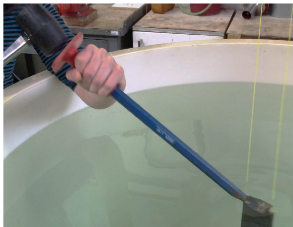
Obrázek 21: Použití ručního sekáče
