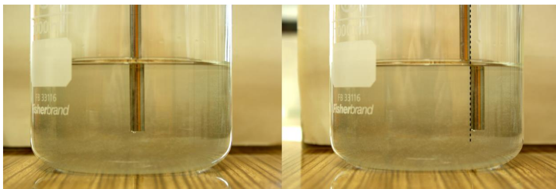
Obrázek 7.4: Měření indexu lomu. Vlevo situace kdy je tyč uprostřed nádoby. Vpravo situace kdy posouváme tyč směrem k okraji nádoby a obraz tyče pod hladinou se zcela oddělí od tyče nad hladinou.
