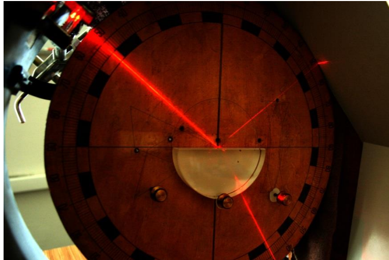
Obrázek 7.9: Sestavení experimentu pro určení Brewsterova úhlu pro sklo
