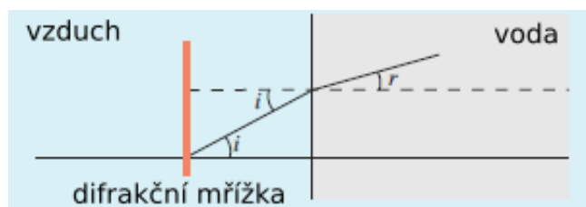
Obrázek 6.2: Lom paprsku na rozhraní vzduchu a vody. Upraveno podle [55]
