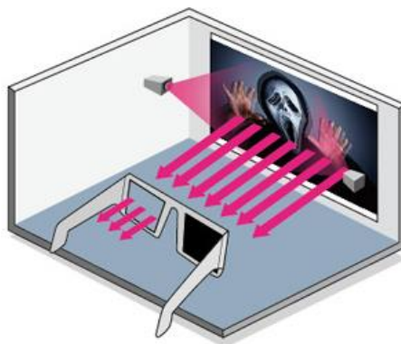
Obrázek 3.9: Princip 3D projekce využívající shutter glasses [45]
