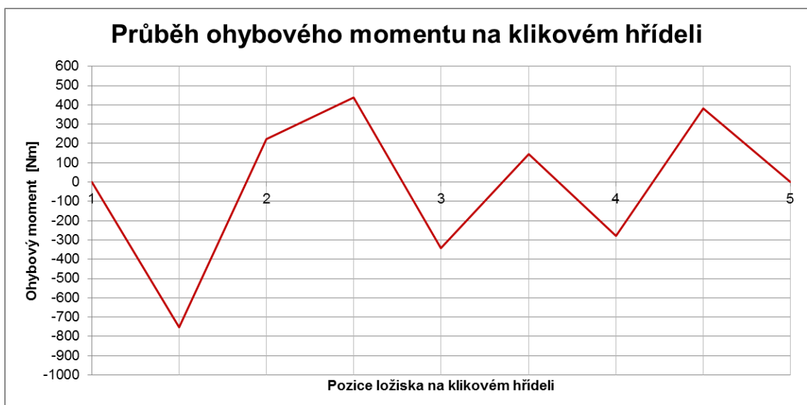
Graf 33: Ohybový moment v klikovém hřídeli při natočení 13° za horní úvratí prvního válce
