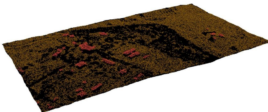
Obrázek 12 - Klasifikovaná LiDARová data (terén, budovy) s odfiltrovanou vegetací Zdroj: autor
