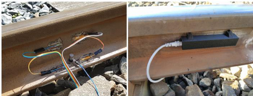
Obrázek 14: První instalace MFC na železniční trať, vlevo první lokalita v roce 2019, vpravo druhá lokalita v roce 2020
