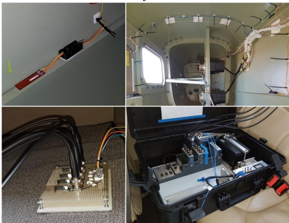
Obrázek 10: Instalace MFC do trupu letadla, vlevo nahoře: detail na senzor, vpravo nahoře: pohled na stringery osazené senzory, vlevo dole: odporový dělič a přepět'ová ochrana, vpravo dole: DAQ ústředna
