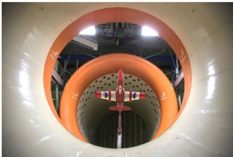
Obr. 10 Uzavřený cirkulační atmosférický aerodynamický tunel s otevřeným měřícím prostorem (převzato z [13]).
