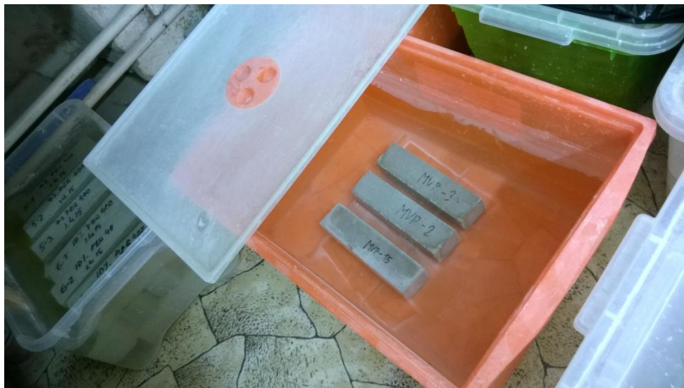
Obr. 6 Vzorky uložené ve vodě
