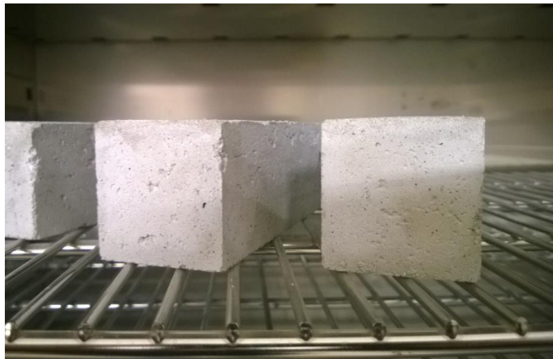
Obr. 5 Vzorky umístěné v sušárně
