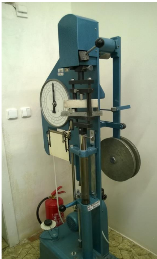
Obrázek 3. Lis pro stanovení pevnosti v tahu za ohybu
