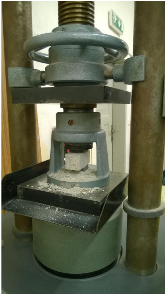
Obrázek 4. Lis pro stanovení pevnosti v tlaku
