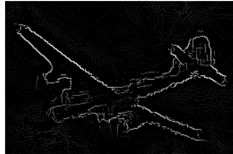
(b) Potlačení nemaximálních hodnot – Cannyho hranový detektor s parametry kernelSize = 13, \sigma = 9 .
