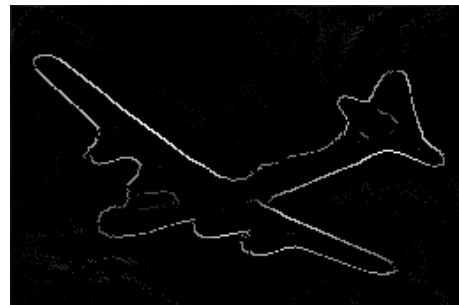
(d) Potlačení nemaximálních hodnot – Derichův detektor s parametrem \alpha = 0,3 .
