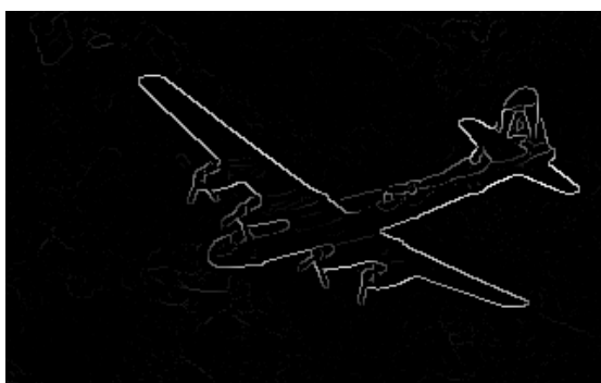
(a) Výstup z Derichova hranového detektoru parametr \alpha = 1,0 .
