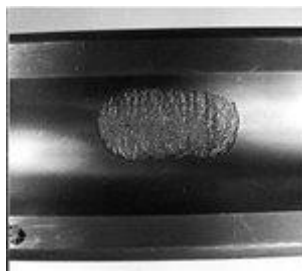
Obr. 1-3 Pitting na vnútornom krúžku ložiska[14].
