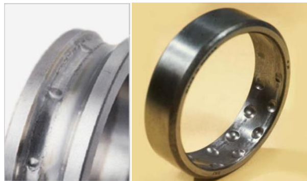
Obr. 1-5 Skutočný (vľavo) a falošný (vpravo) brinelling [17].
