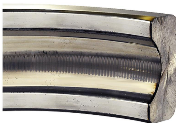
Obr. 1-8 Galvanická korózia na dráhe vonkajšieho krúžku [20].
