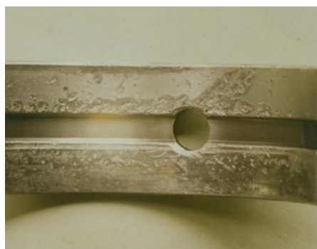
Obr. 1-7 Kavitácia v okolí olejových drážok [19].
