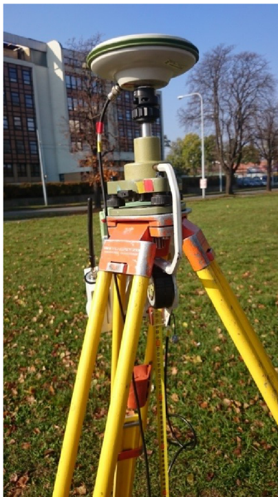
Obr.č. 5.3 Výškové odsazení spolu s hákem společnosti Leica [9]
