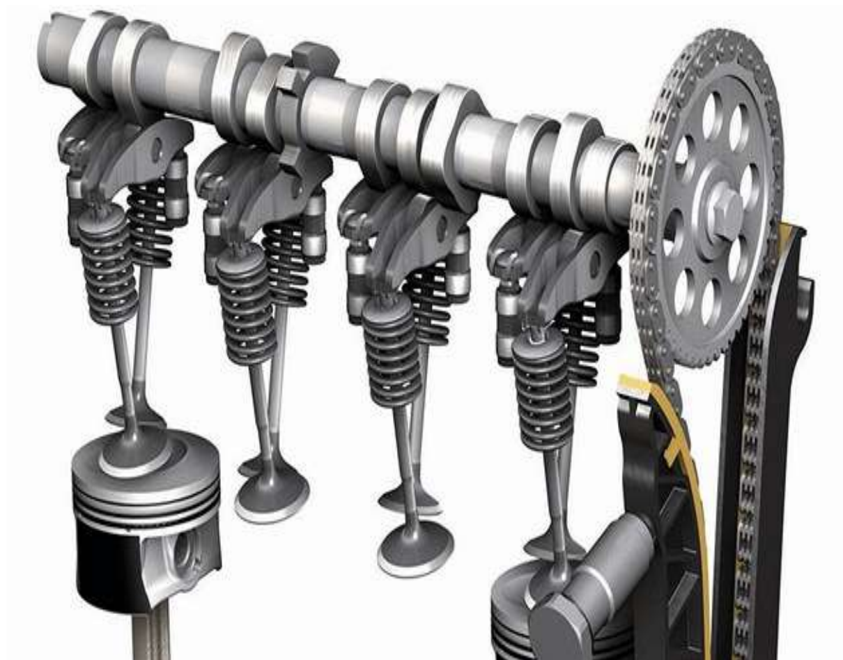
Obr.1 Model ventilů ve čtyřválcovém spalovacím motoru [39]
