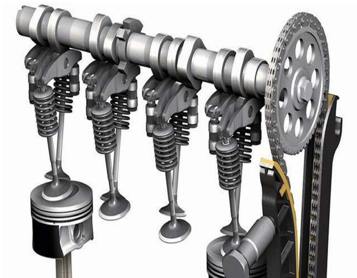
Obr.1 Model ventilů ve čtyřválcovém spalovacím motoru [39]
