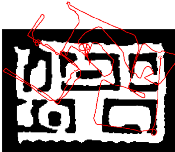
obr. 3.1: Vliv chyb odometrie na vypočtenou trajektorii mobilního robota. Převzato z (5)
