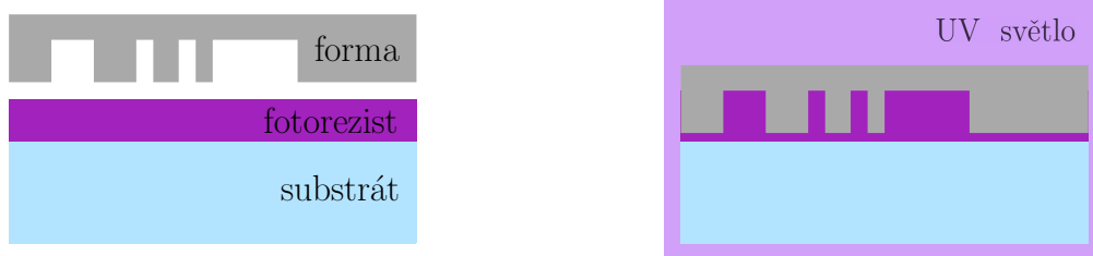
(a) Příprava substrátu s fotorezistem a formy. (b) Vytvrzení fotorezistu pomocí UV světla.
