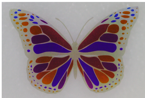
Obrázek 6.22: Návrh a experimentální výsledek ochranného prvku z kruhových Al nanodisků pro kolmý dopad.
