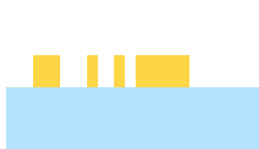
(f) Odleptání reziduální vrstvy rezistu.
