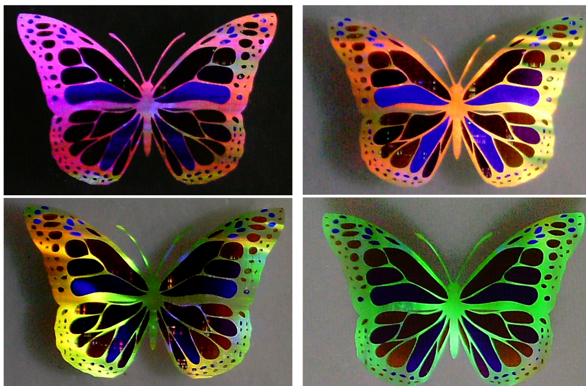
Obrázek 6.23: Výsledek experimentálního vytvoření ochranného prvku při dopadu budícího záření pod různými úhly.
