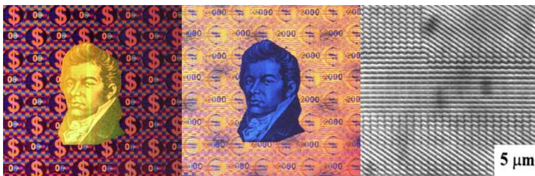
Obrázek 3.2: Příklad Exelgramu zobrazeného pod dvěma různými úhly a vzor difrakční mřížky. Převzato z [38].
