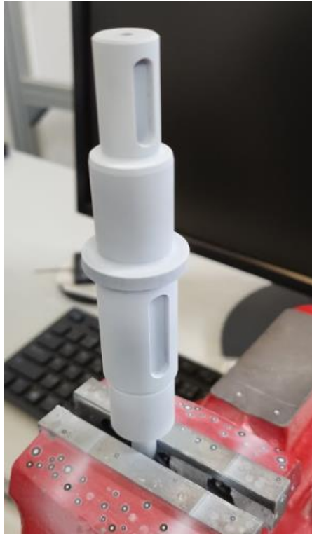
Obr. 52 Použití zmatňujícího nástřiku na navržený hřídel.
