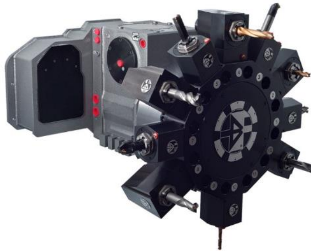
Obr. 11 Příklad revolverové hlavy [22].
