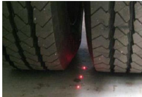
Obr. 3 a 4 Tuhý nosník s Doppler-laser snímači uvnitř návěsu zařízení TSD (vlevo); laserové paprsky třech snímačů na povrchu měřené vozovky (vpravo) [foto: archiv autora]
