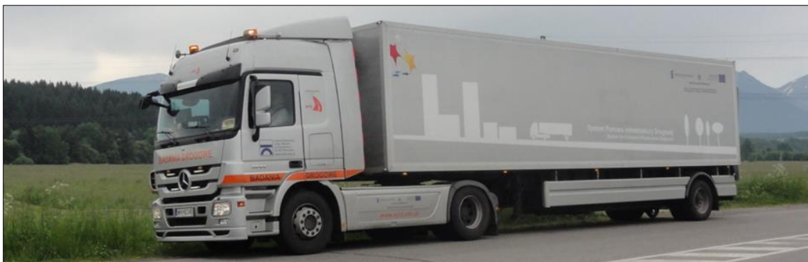
Obr. 1 Traffic Speed Deflectometer, vlastník IBDiM (Polsko) [foto: archiv autora]
