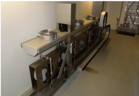
Obr. 3 a 4 Tuhý nosník s Doppler-laser snímači uvnitř návěsu zařízení TSD (vlevo); laserové paprsky třech snímačů na povrchu měřené vozovky (vpravo) [foto: archiv autora]
