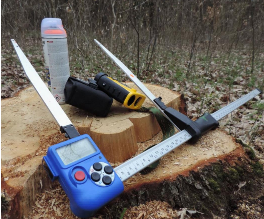
Obr. 23: Výbava každého měřiče ( elektronická průměrka, laserový výškoměr a vyznačovací sprej )
