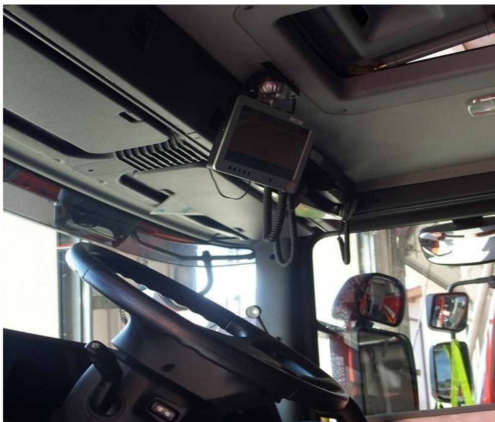
Obr. 5: Příklad umístění monitoru navigace u vozidla CAS 20 Scania 4x2.
