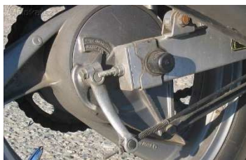
Obrázek 38 - Kontrola obložení bubnových brzd
