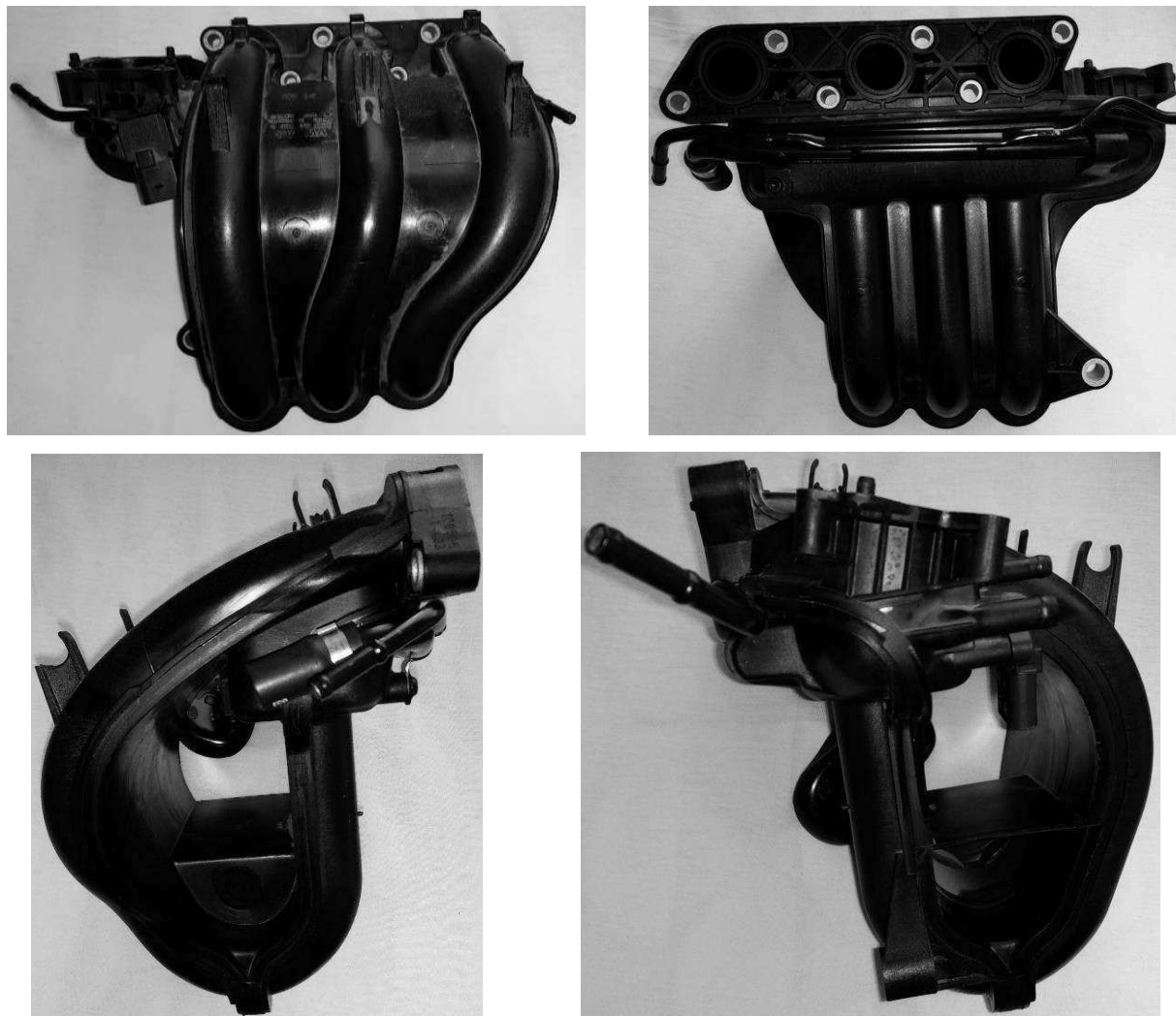
Obr. 35 Originální konvenční sací potrubí motoru 1.2 HTP 40 kW (6-ti ventilová technika)
