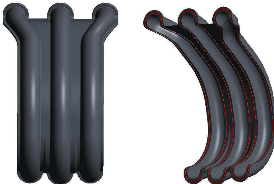
Obr. 39 3D model druhého dílu navrhovaného sacího potrubí
