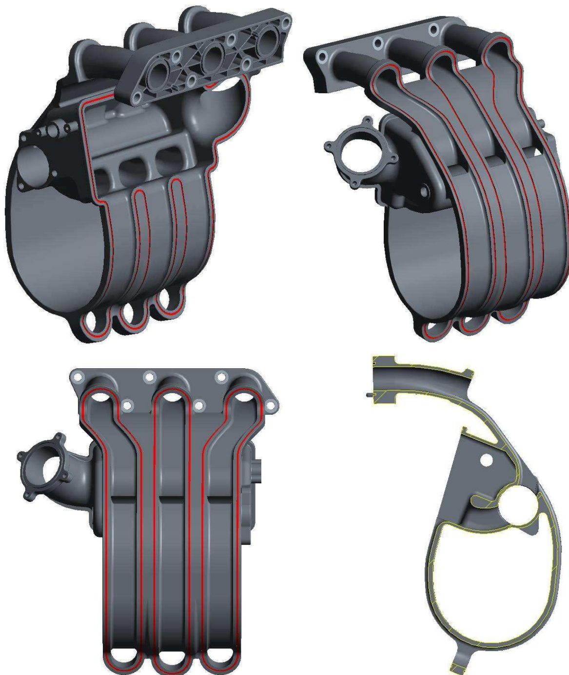
Obr. 38 3D model hlavního dílu navrhovaného sacího potrubí
