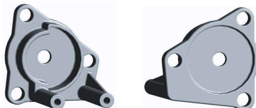
Obr. 42 3D model příruby rotačního šoupátka
