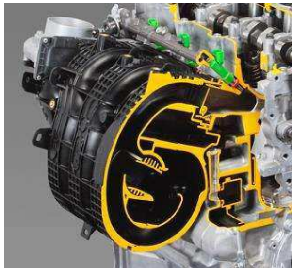
Obr. 12 Dvoustupňové sací potrubí – motor Toyota 2.7l [12]
