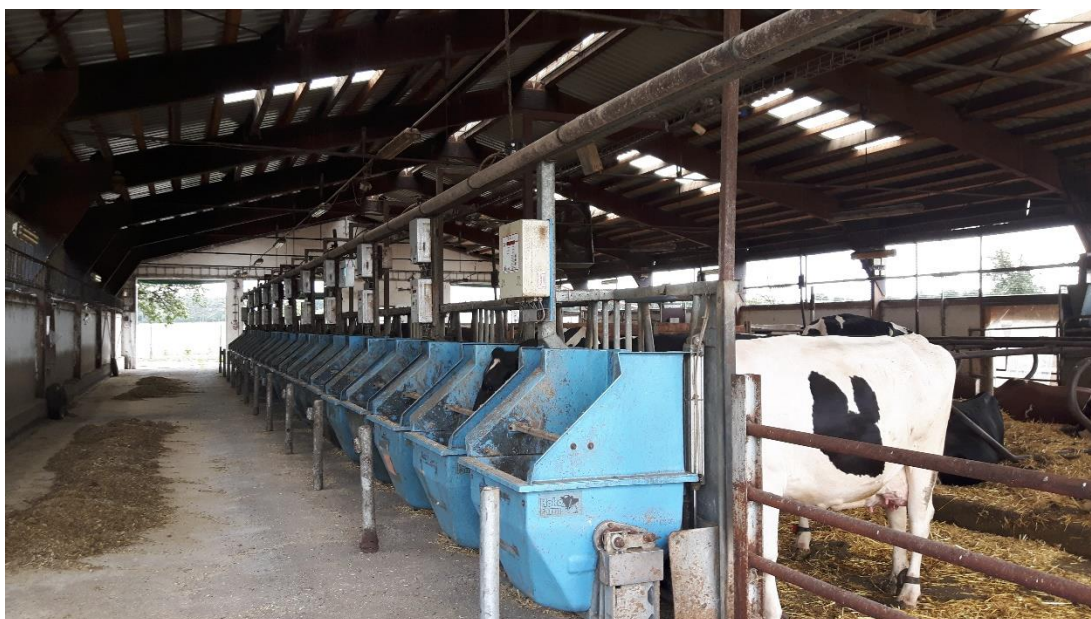
Obrázek 13: Pokusná stáj – krmná chodba se žlaby na tenzometrických vahách (vlastní fotografie)
