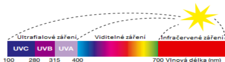
Obrázek 1 – Spektrum elektromagnetického záření a rozdělení UV záření; upraveno [2]
