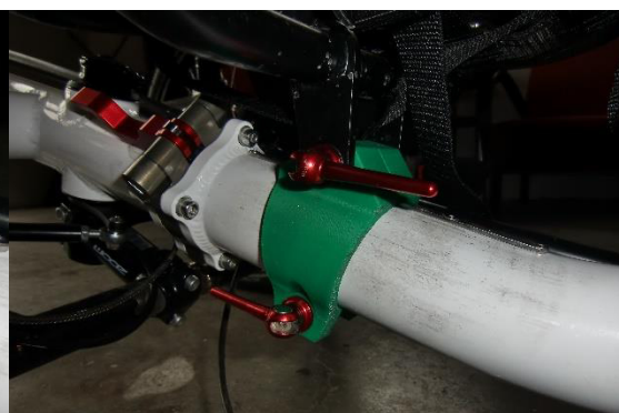
Obr. 5.2 Upevnění sedačky do objímky z ABS.
