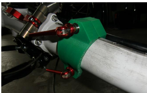
Obr. 5.1 Upevnění objímky z ABS na rám kola.
