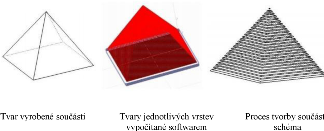
Obr. 1.1 Obecný proces vzniku součásti [8].
