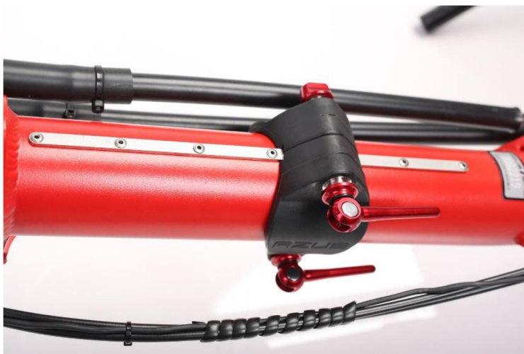
Obr. 2.1 Držák sedla vyvinutý firmou AZUB bike s.r.o. [22].
