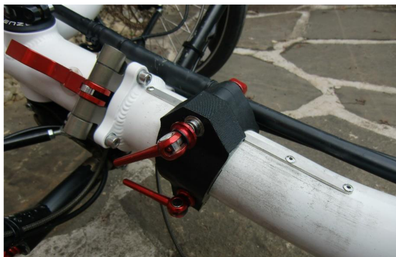
Obr. 5.5 Součást z PLA plastu v době po zátěžovém testu.
