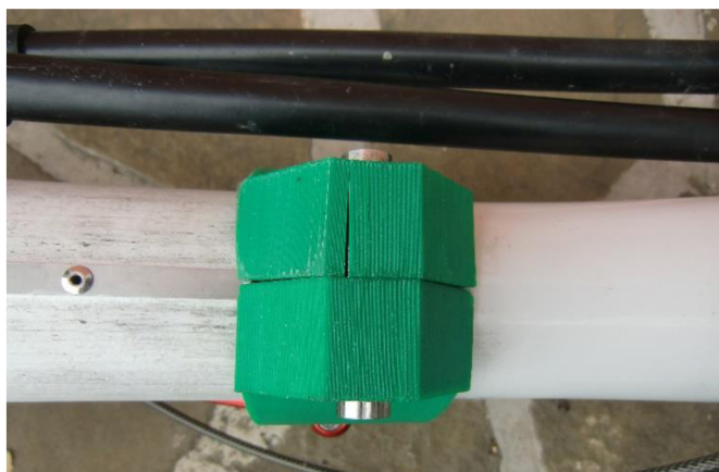
Obr. 5.3 Trhlina vzniklá po zátěžovém testu u ABS plastu.
