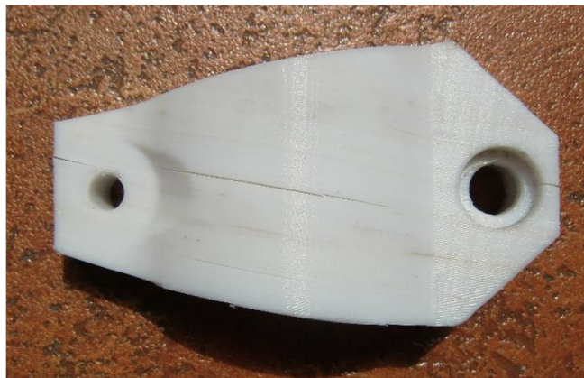
Obr. 5.4 Trhlina vedená celým objemem materiálu. PC při dotahování popraskal.
