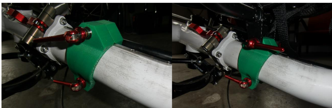
Obr. 5.1 Upevnění objímky z ABS na rám kola.
