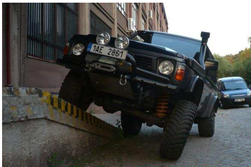
Obr. 4 – Vozidlo Nissan Patrol – zkoušení křížení náprav
