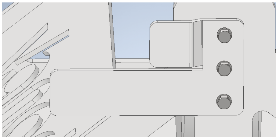
Obrázek 44 Detekční plech polohy lunety.
