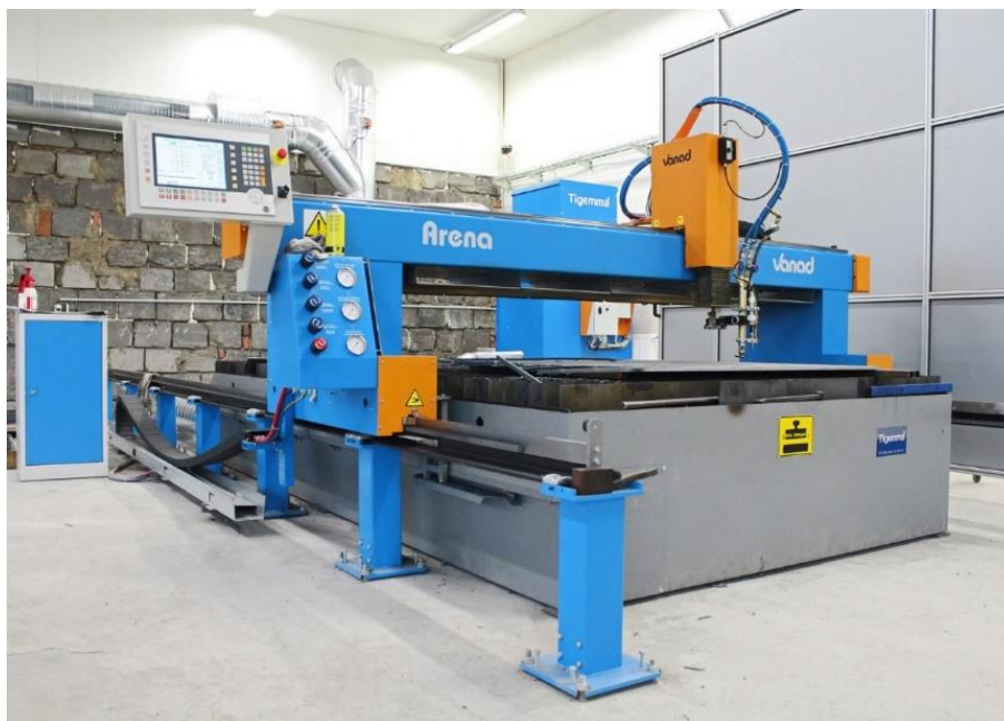
Obrázek 6 Klasická koncepce CNC pálicího stroje [4].
