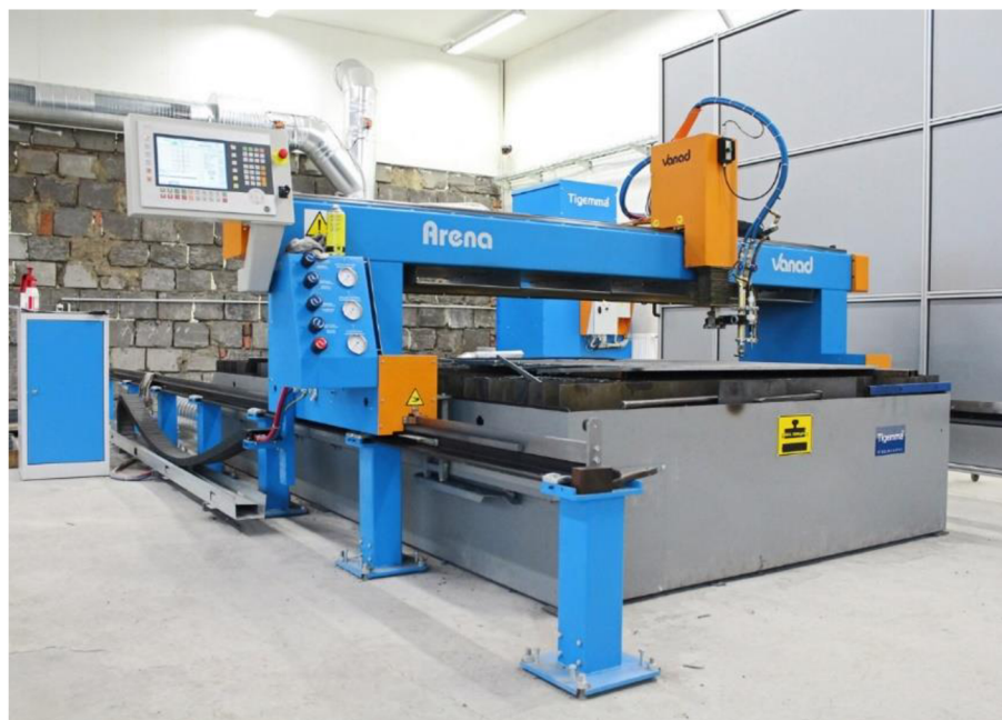
Obrázek 6 Klasická koncepce CNC pálicího stroje [4].
