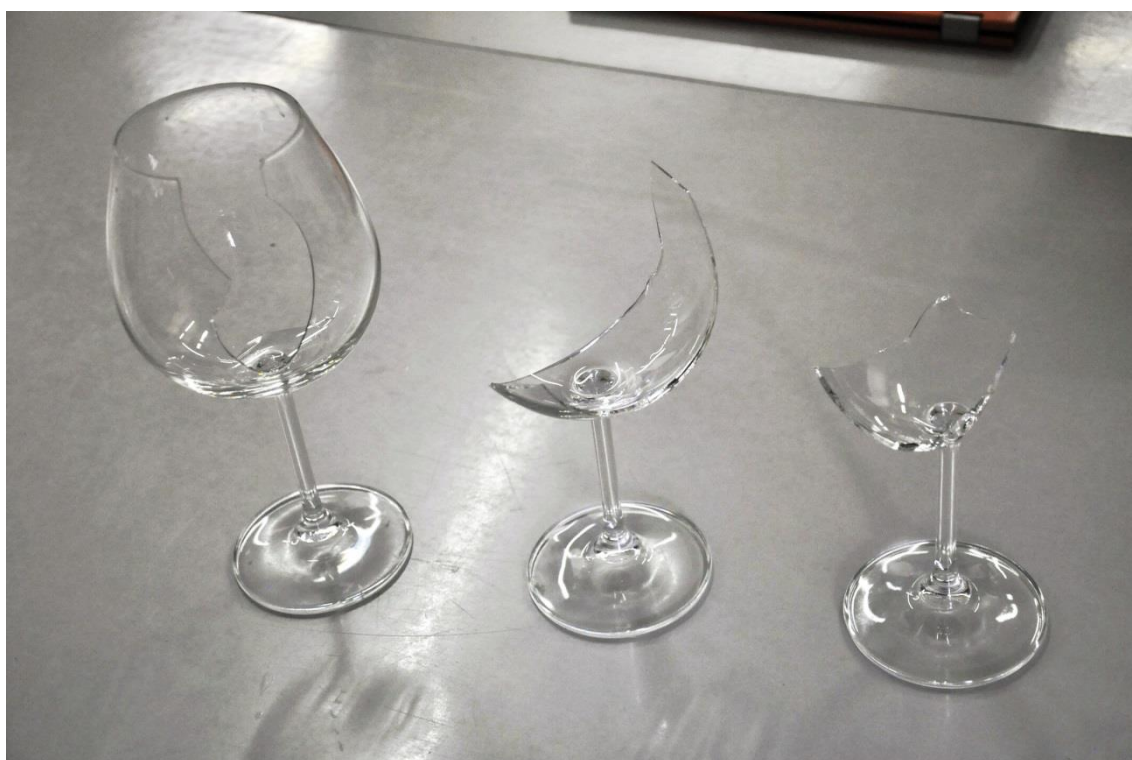
Výsledky působení zvuku na sklenici v rezonanci.
