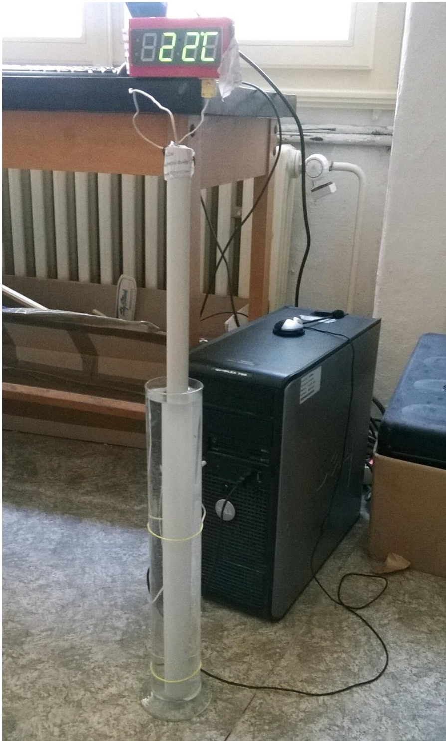
Měření rychlosti zvuku v odměrném válci.
