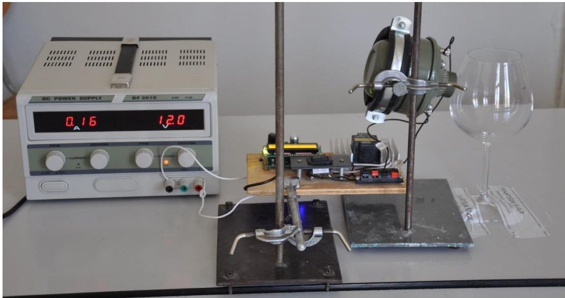
Obr. 29 Konstrukce působení zvuku na sklenici s tlakovým reproduktorem
