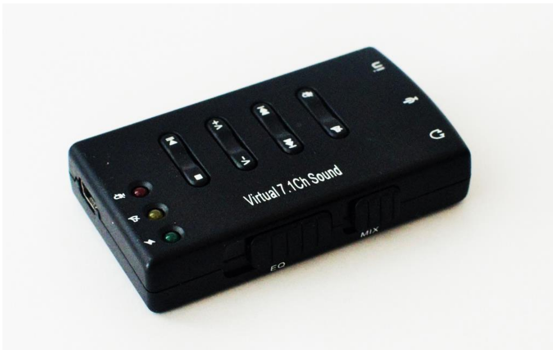
Zvuková karta použitá při měření rychlosti vlnění na struně
