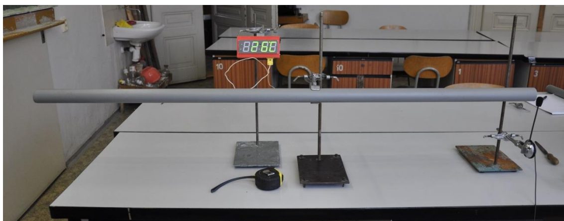
Obr. 18 Konstruktce měření rychlosti zvuku v trubce
