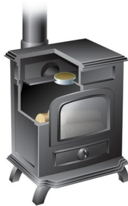
Obrázek 4-8 Příklad umístění katalyzátoru v krbových kamnech [95]
