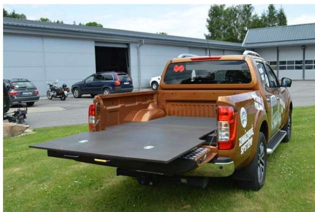
10-125: Reálná konstrukce pokrytá plechovou plošinou
