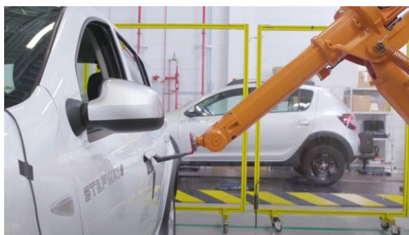
Obrázek 10-78 Testování dveří v automotive [Zdroj: DACIA Group Renault]
