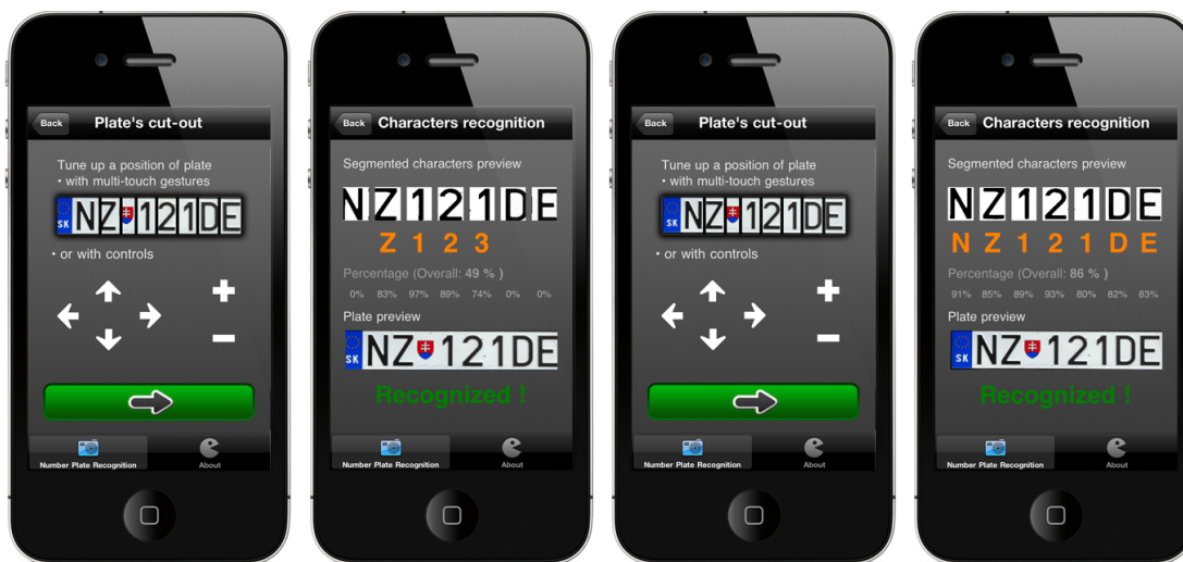
(a) Automatická lokalizácia (b) Rozpoznanie znakov bez doladovania pozície značky (c) Doladená lokalizácia značky (d) Rozpoznanie znakov s dodatočným doladením značky
