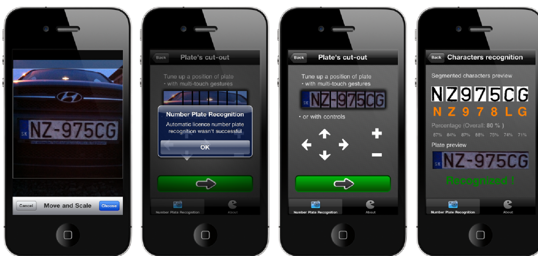
(a) Zvolená fotografia (b) Značka nebola automaticky rozpoznaná (c) Doladená lokalizácia značky užívateľom (d) Rozpoznanie znakov s dodatočným doladením užívateľom
