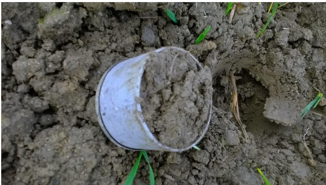
Obr.č.8: Kopeckého váleček obsahující půdní vzorek (archiv autorky, 2017)
