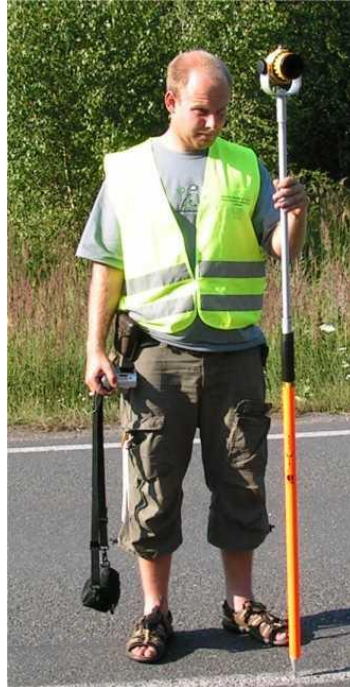
Obrázek 6 Měřené body volí pracovník s koutovým odražečem zdroj: ŠACHL, Jindřich, Zora ŠACHLOVÁ a Richard MITÁŠ. Soudní znalectví v silničním provozu. Praha: Policejní akademie České republiky v Praze, 2020. ISBN 978-80-7251-508-0. kap. 6
