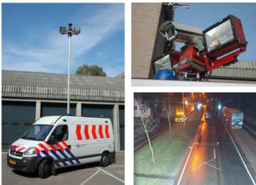
Obrázek 7 Detailní pohled na zařízení využívané k dokumentaci míst nehod holandskou policií zdroj: ŠACHL, Jindřich, Zora ŠACHLOVÁ a Richard MITÁŠ. Soudní znaleství v silničním provozu. Praha: Policejní akademie České republiky v Praze, 2020. ISBN 978-80-7251-508-0. kap. 6
