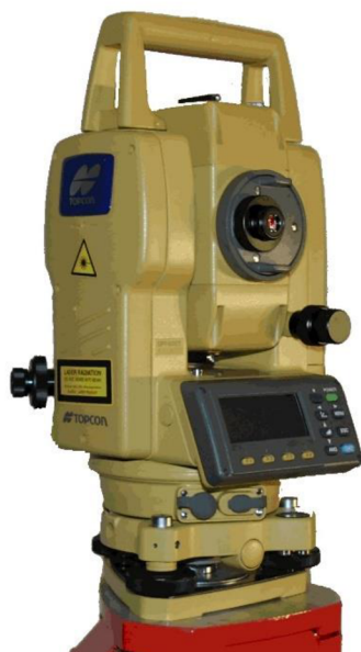
Obrázek 4 Total-Station TOPCON GPT 3007 zdroj: ŠACHL, Jindřich, a kol. Analýza nehod v silničním provozu . V Praze: České vysoké učení technické, 2010. ISBN 978-80-01-04638-8.
