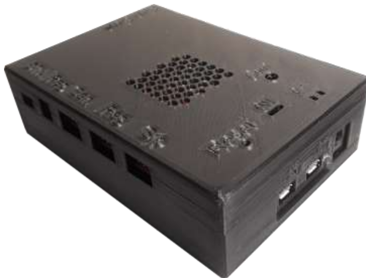
Obrázek 33 – Kryt řídicí jednotky
