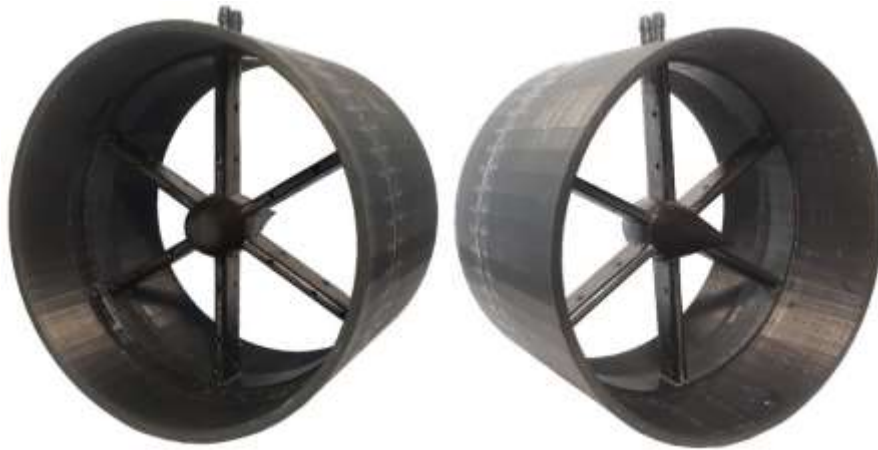
Obrázek 28 - Vytisknutý díl Wilsonovy mříže
