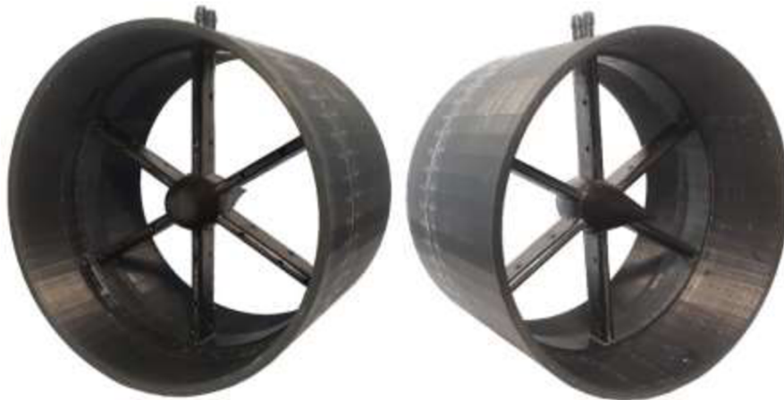
Obrázek 28 - Vytisknutý díl Wilsonovy mříže
