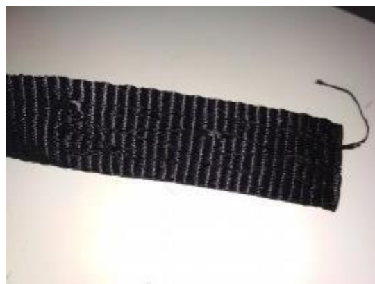
Obrázek 55 - Popruh po deformaci P3, tvar 5. Destrukce šitého materiálu.
