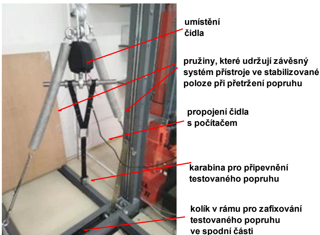
Obrázek 38 – Zařízení použité k testování pevnosti popruhů
