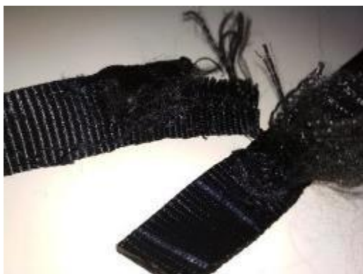
Obrázek 54 - Popruh po deformaci P2, tvar 4. Destrukce šitého materiálu.
