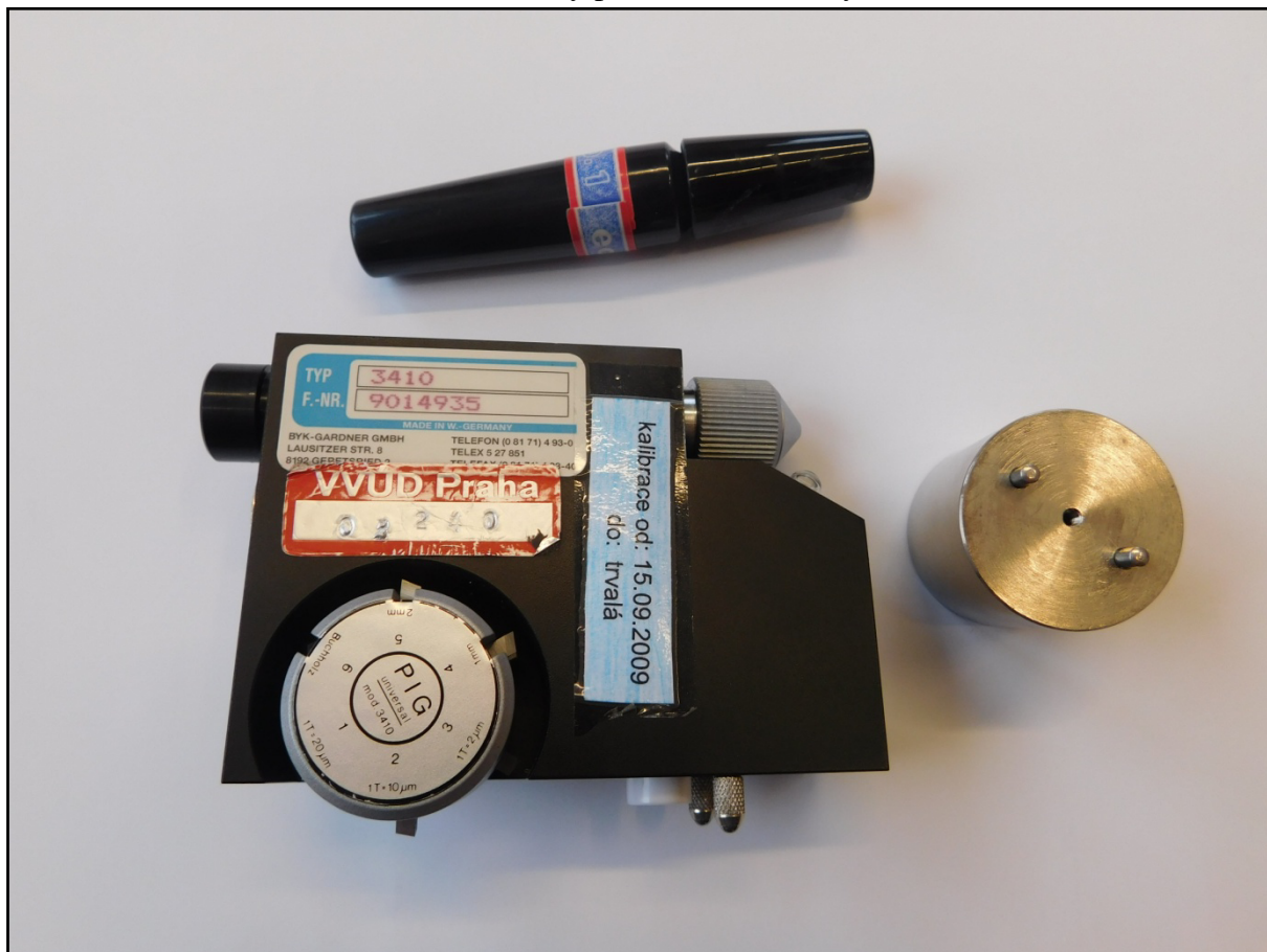
Obr. 4 Tloušťkoměr určený pro měření hloubky klínového řezu
