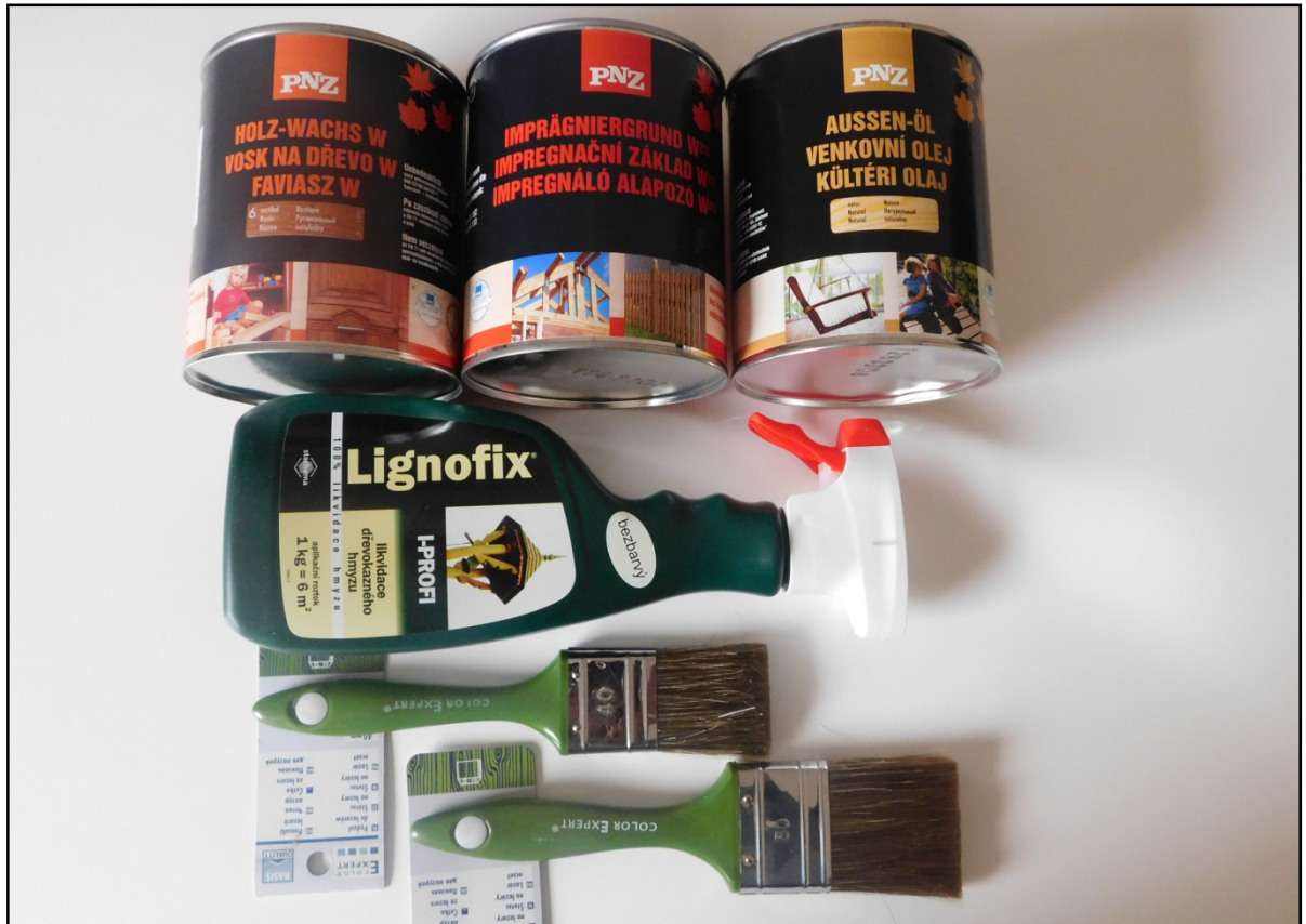
Obr. 1 Nátěrové hmoty včetně modifikací použitých na zkušební tělesa
