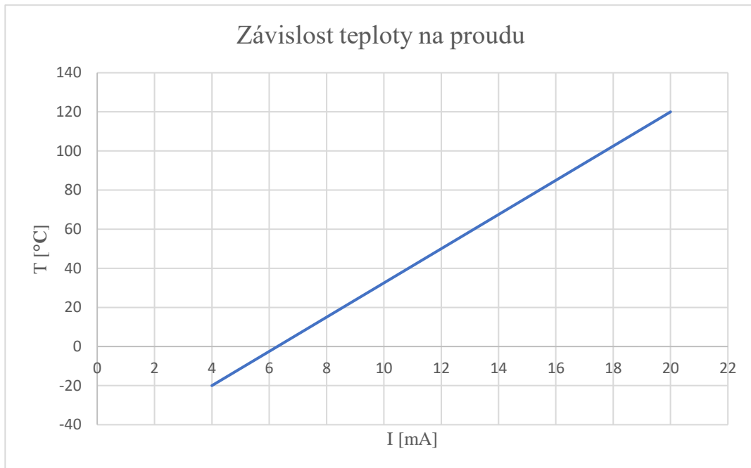
Obrázek 1.8 Graf závislosti teploty na protékajícím proudu termistoru
