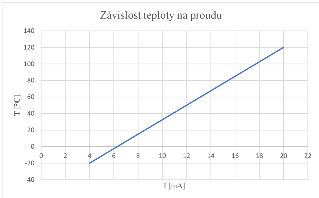
Obrázek 1.8 Graf závislosti teploty na protékajícím proudu termistoru
