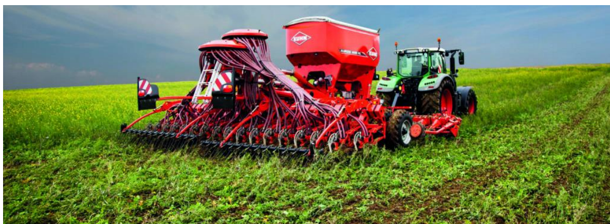
Obrázek 3 Přímé setí strojem AUROCK 6000 R/RC značky KUHN
