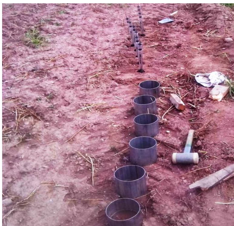
Obrázek 14 Měření Mini Disky a SFH metodou
