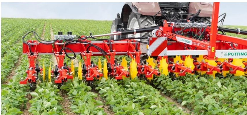
Obrázek 8 Radličková plečka FLEXCARE od firmy Pöttinger
