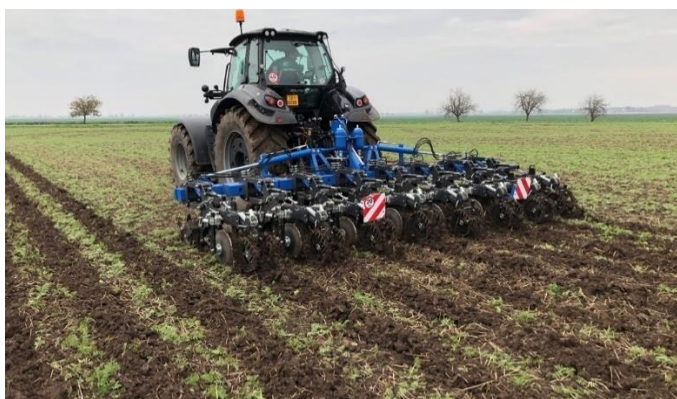
Obrázek 2 Stroj pro pásové zpracování půdy Eco Tiller 600
