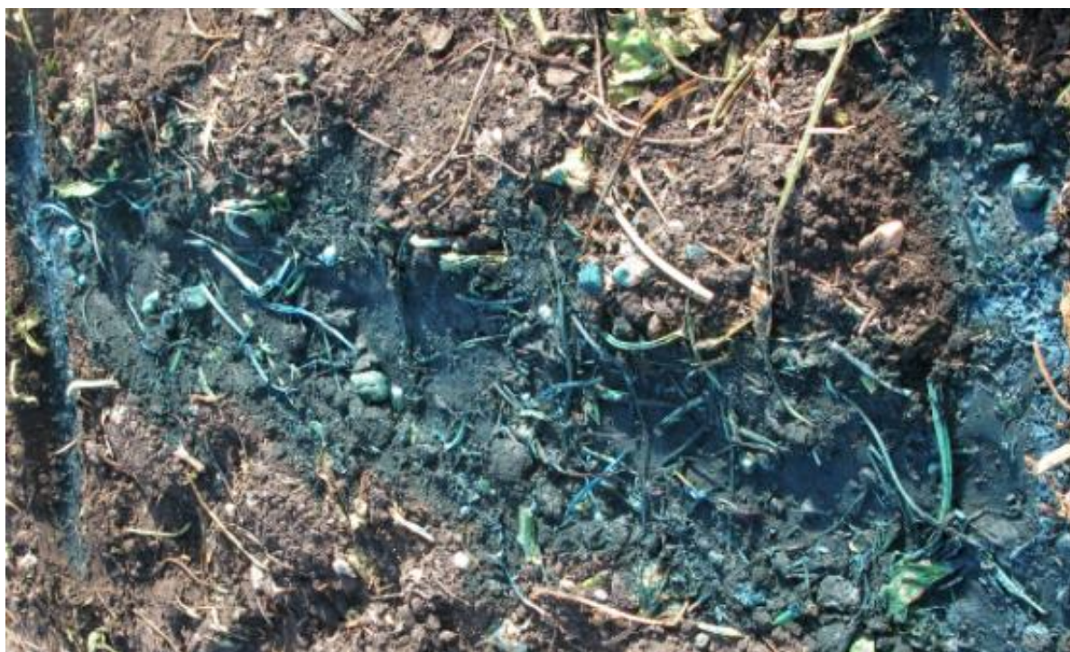
Obrázek 15 Povrch po aplikaci roztoku Brilantní modři.
