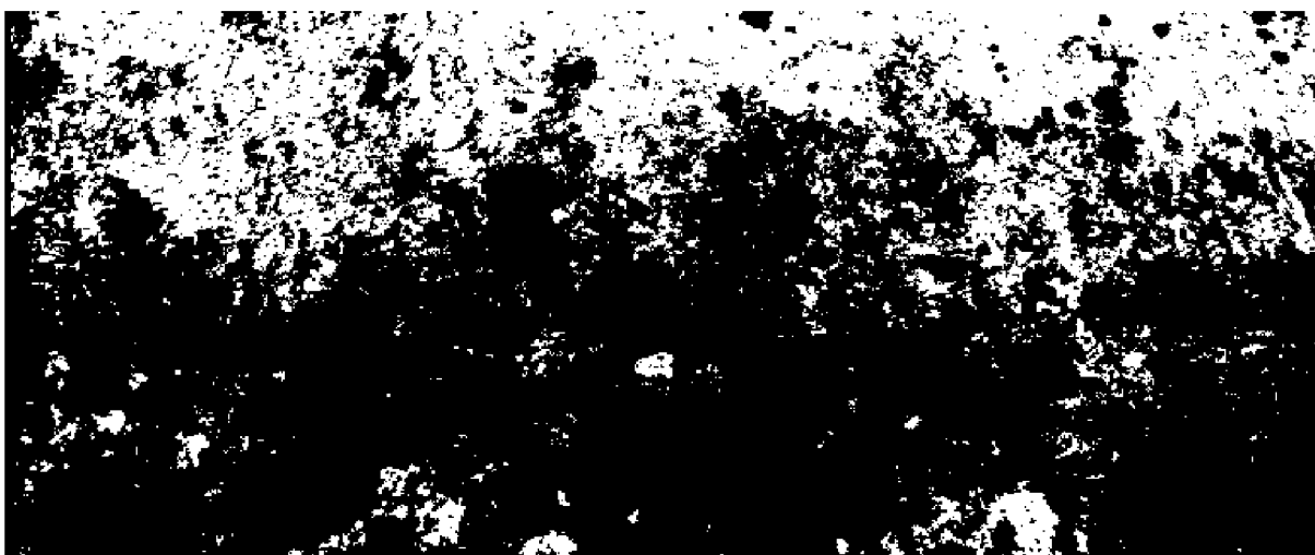
Obrázek 19 Snímek infiltrace barviva varianty 4 po převedení
