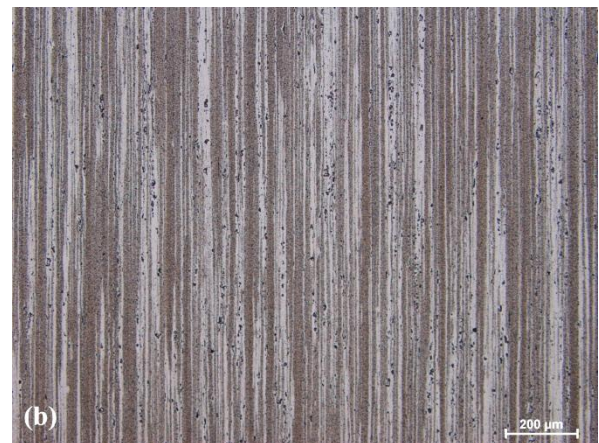
Obr. 21 Struktura materiálu D (Al slitina 6061) a) zv. 500x (SM), b) zv. 100x (SM).
