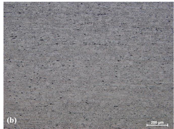
Obr. 20 Struktura materiálu C (AlMg5) a) zv. 500x (SM), b) zv. 100x (SM).
