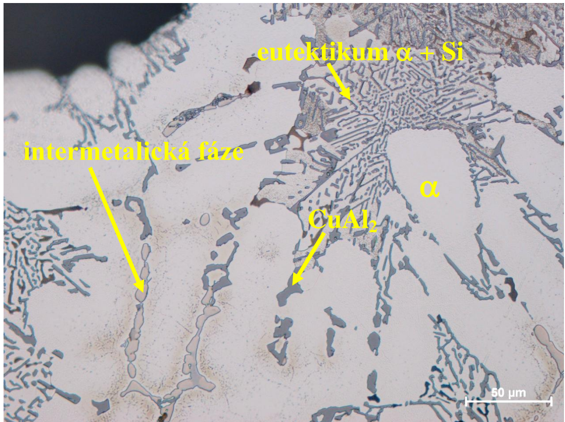
Obr. P1.5 Základní struktura materiálu D (AlSi9Cu3) - zvětšení 500x (SM).
