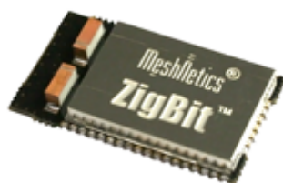
Obr. 16 ZigBit modul s dvojitou čipovou anténou
