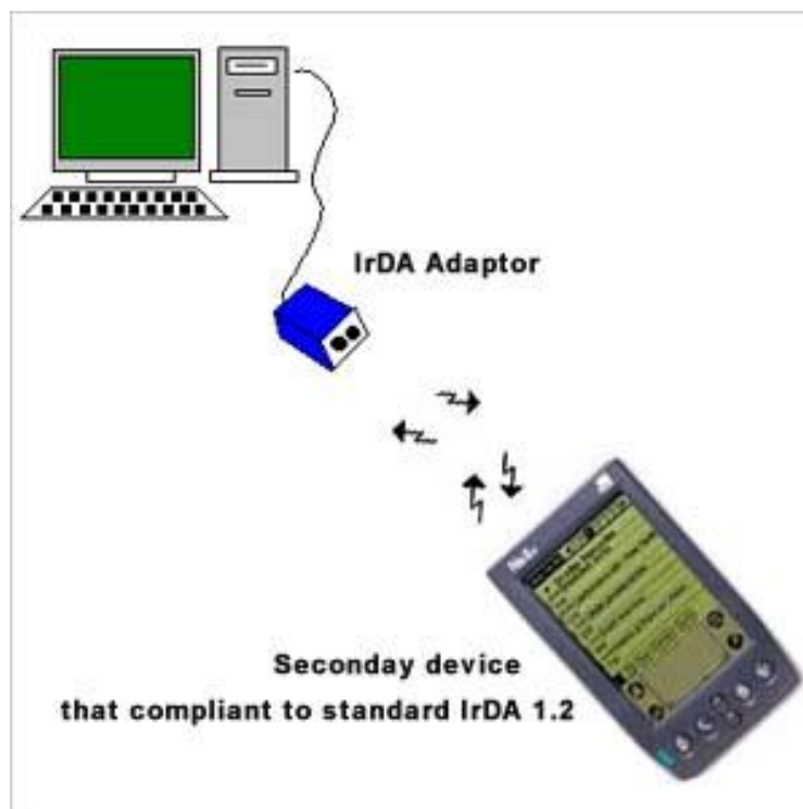
Obr. 13 Komunikace mobilního zařízení přes IrDA adaptér
