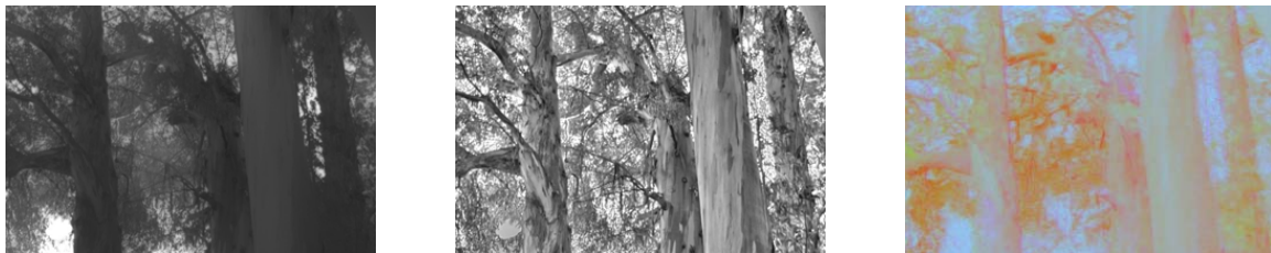
Obrázek 5.3: Obrazy jednotlivých vrstev, vytvořených ze vstupního obrazu. Základní vrstva, detailní vrstva, oddělená barevná informace [33]
