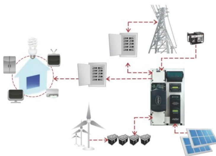
Obr. 8 Hybridní fotovoltaický systém
