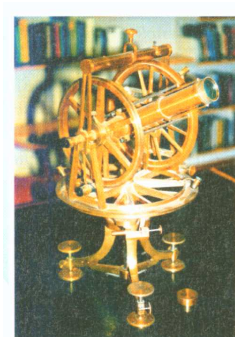
Obr. 3-1 Reichenbachův repetiční teodolit (17)
