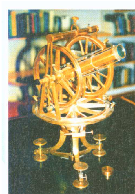
Obr. 3-1 Reichenbachův repetiční teodolit (17)
